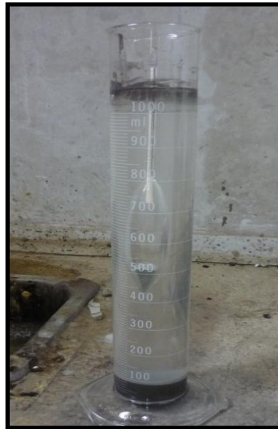
Figura 5.5 Ensayo de granulometría del material fino.
