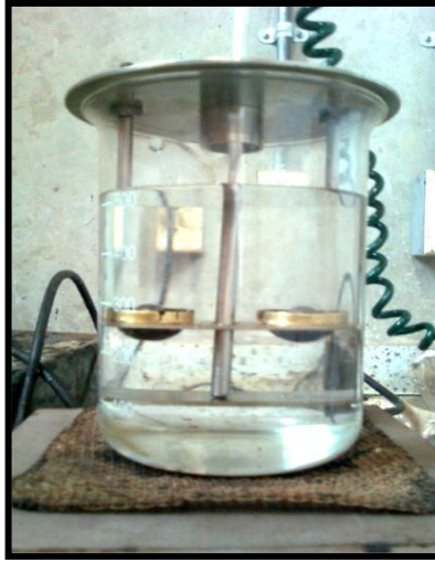
Figura 5.27 Ensayo de punto de ablandamiento para el asfalto.
