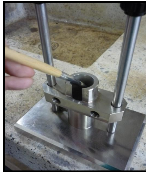
Figura 5.21 Compactación y limpieza del material adherido al aparato.
