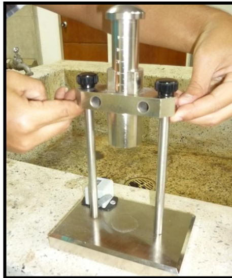
Figura 5.21 Compactación y limpieza del material adherido al aparato.
