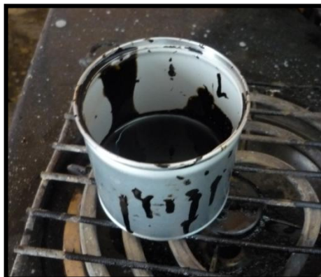
Figura 5.24 Calentado del asfalto en la estufa.
