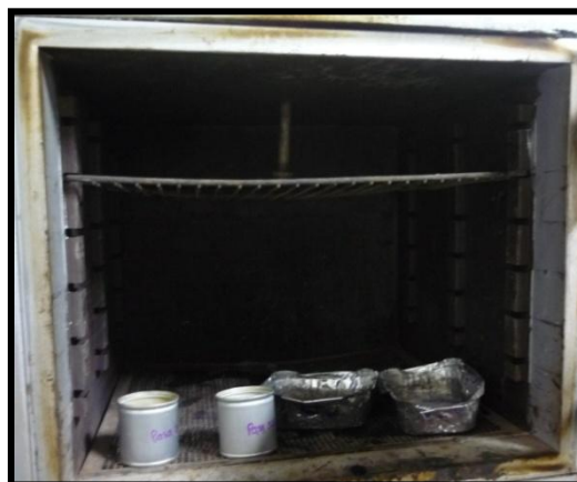
Figura 5.3 Secado de la muestra en el horno
