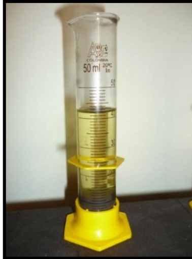
Figura 5.16 Sedimentación de la muestra.
