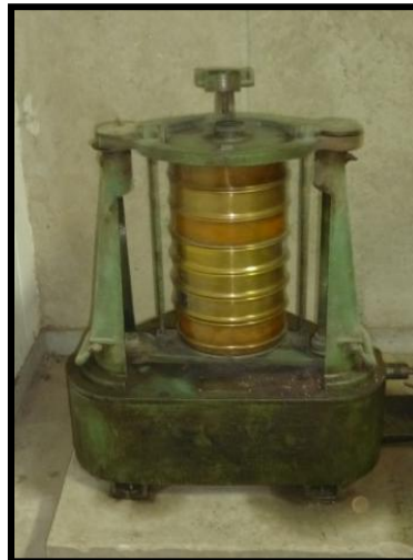
Figura 5.1 Tamizado del material en seco.
