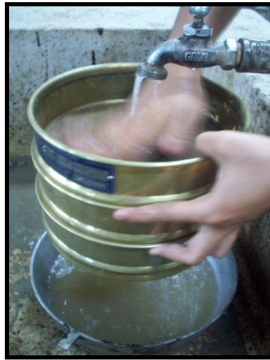
Figura 5.2 Tamizado del material con lavado.
