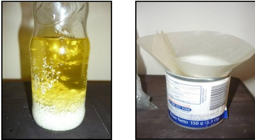
Figura 5.15 Deshidratación y filtración del kerosene.
