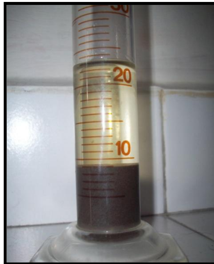
Figura 5.19 Medición de volumen después de 24h.
