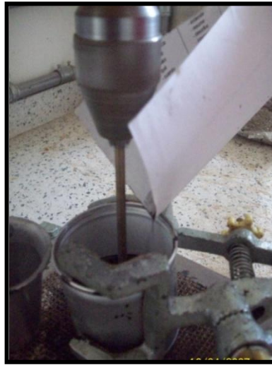
Figura 5.25 Adición del filler al ligante asfáltico
