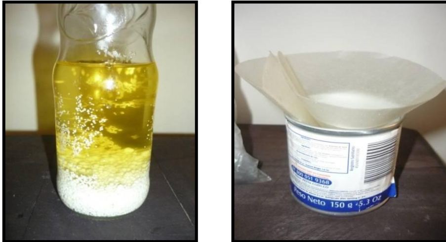
Figura 5.17 Deshidratación y filtración del kerosene.
