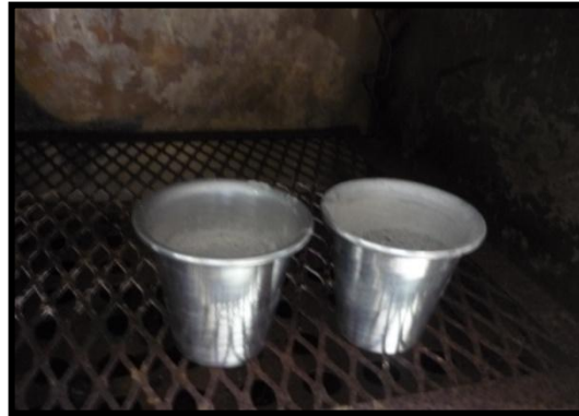
Figura 5.23 Calentado del filler en el horno.
