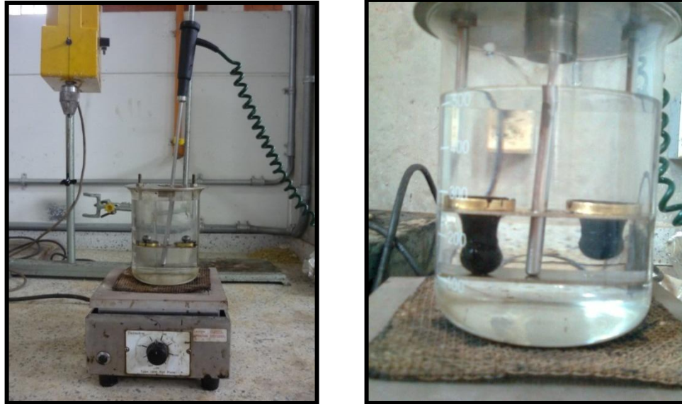
Figura 5.29 Ensayo de punto de ablandamiento para el mástico.
