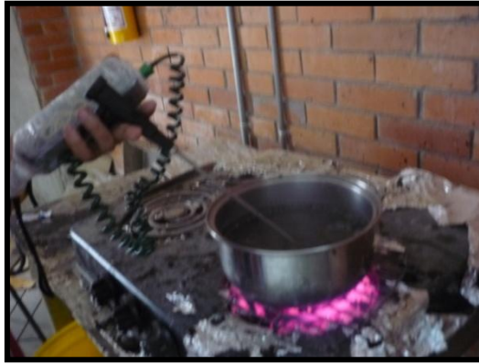
Figura 5.4 Secado de la muestra en la estufa y retirado del recipiente.
