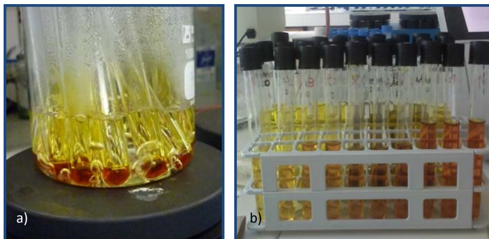
Figura 23: a) y b) Método DNS para cuantificación de ART.
