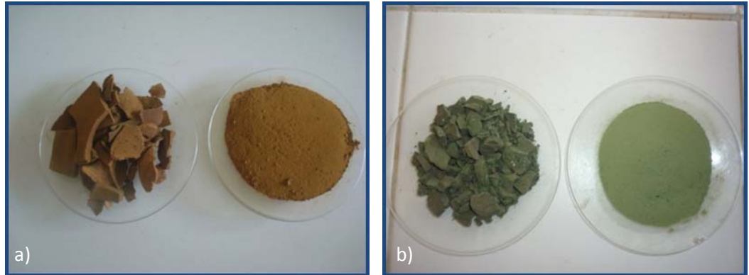
Figura 17: a) Ch. Gracilis 150 ppm de floculante FeCl_3 macerada y sin macerar, b) Ch. Calcitrans 30 ppm de floculante FeCl_3 .
