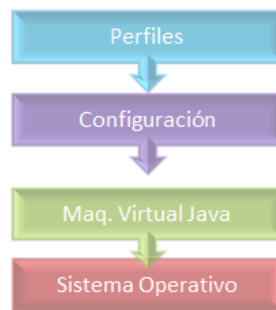
Figura 4: Arquitectura de un entorno de ejecución
