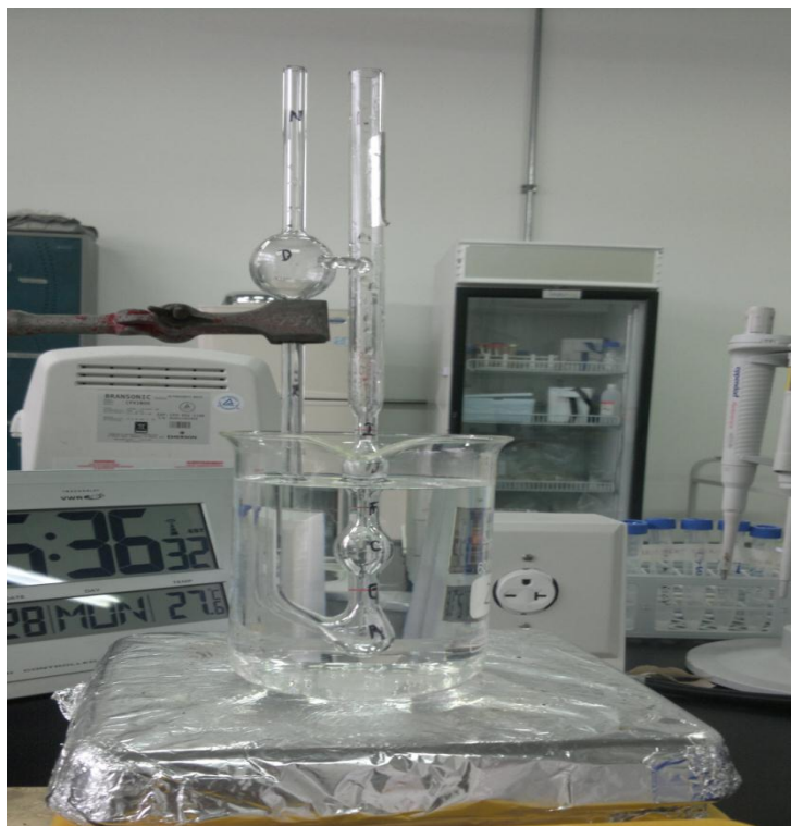
Figura 19. Montaje para la determinación de viscosidad intrínseca con viscosímetro Cannon-Fenske.
