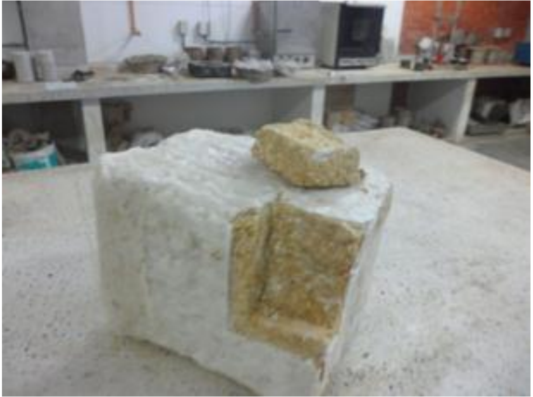
Figura 4. Tallado y extracción del espécimen de tamaño similar al del anillo de corte
