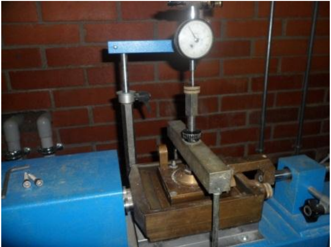
Figura 6. Montado de la caja de corte y micrómetro vertical
