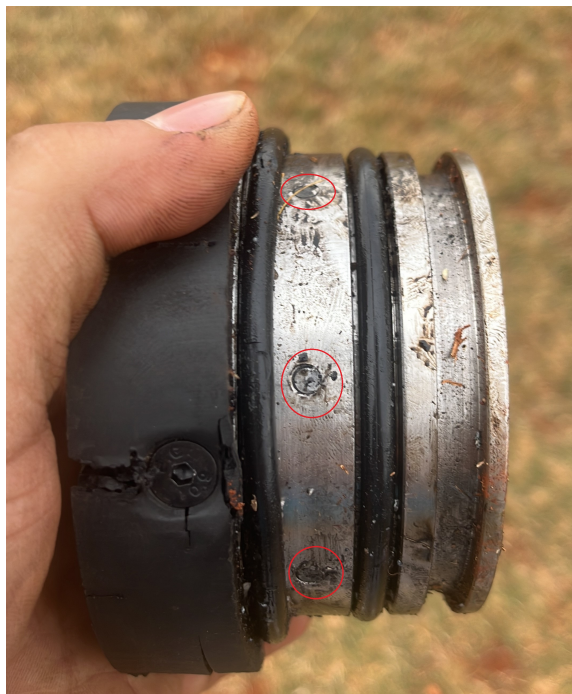
Figura 41. falla por cortante de los pernos
