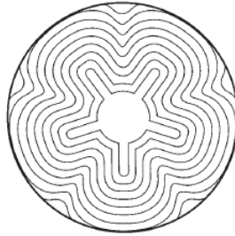
Figura 10. Líneas de quemado radial de la configuración geométrica
