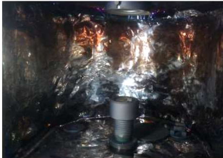
Figura 20. Cámara de descargas del reactor MOSMET
