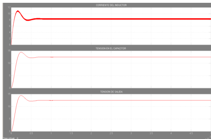
Figura 24. Tensión en el condensador, corriente en el inductor y tensión de salida del convertidor de potencia de la etapa de almacenamiento de energía del modelo conmutado.
