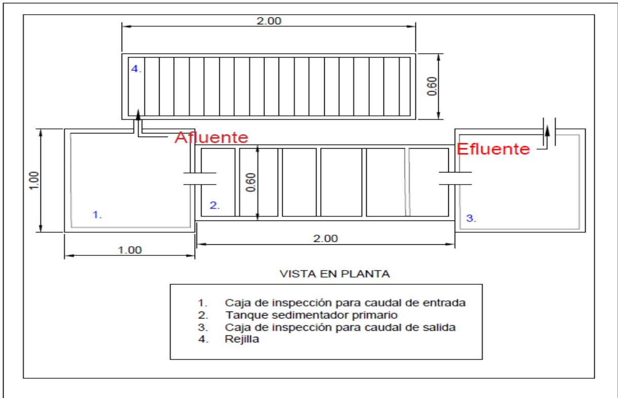
Figura 3. Sedimentador, Vista en planta
