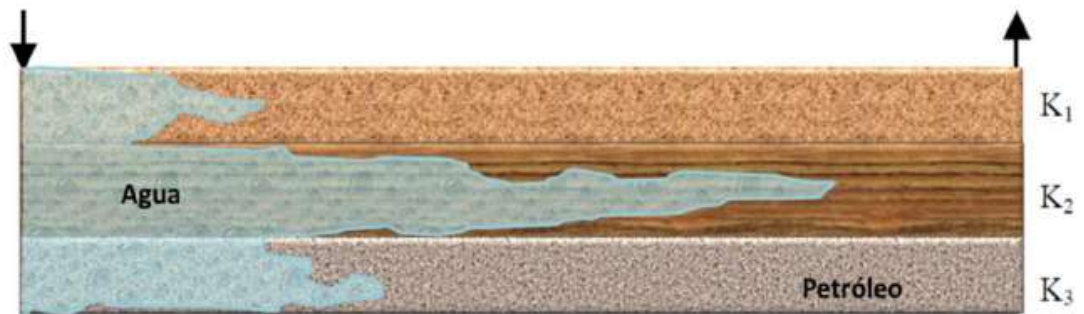
Figura 15. Diagrama esquemático de Eficiencia vertical por la inyección de agua en un yacimiento heterogéneo.
