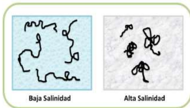
Figura 9. Efecto de una solución altamente ionizada sobre la poliacrilamida hidrolizada
