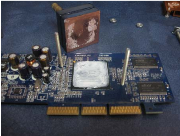
Figura 34. Aplicación de la resina térmica.
