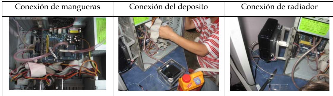
Figura 36. Conexión de las mangueras
