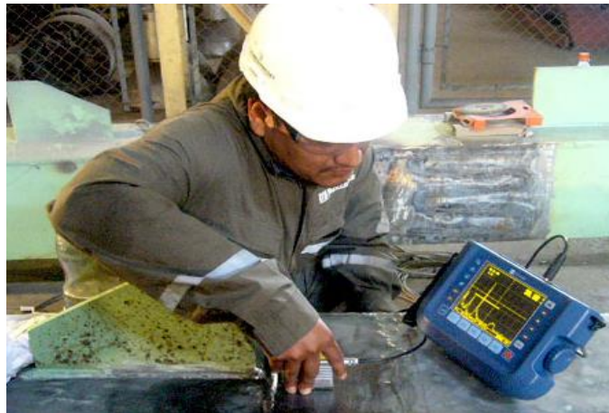
Figura 21. Aplicación de Ultrasonido a un material
