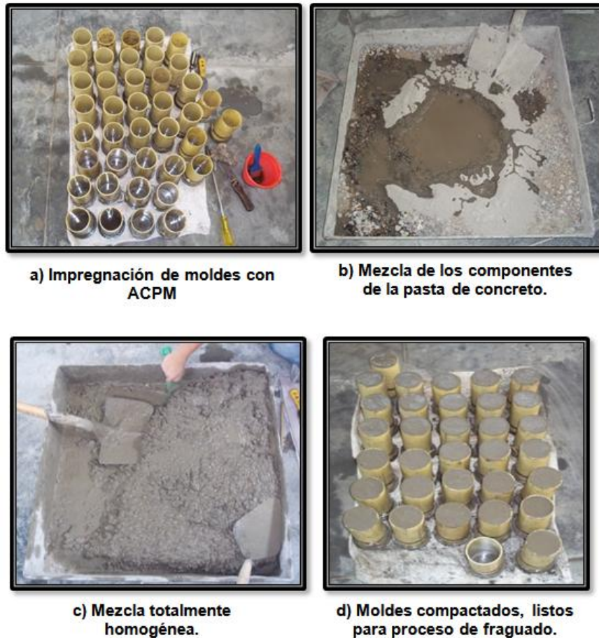
Figura 6. Proceso de elaboración de las probetas
