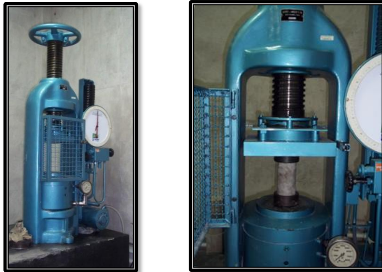
Figura 9. Máquina análoga de ensayos a compresión marca AMSLER
