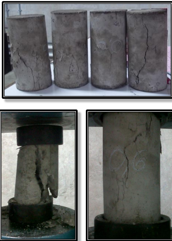
Figura 28. Líneas de falla presentadas en los cilindros ensayados
