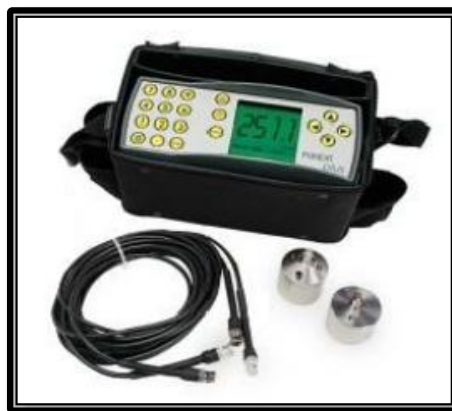
Figura 7. Ultrasonido de baja frecuencia, MODEL PC 1006 tipo PUNDIT PLUS marca CNS FARNELL
