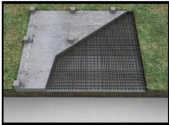
Figura 4: losa de cimentación
