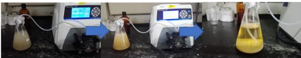
Figura 11. Proceso de oxidación avanzada de sulfuros con el uso de MnSO_4 .
