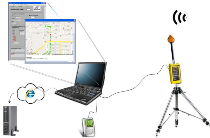
Figura 23. Montaje para la Medición de la Radiación
