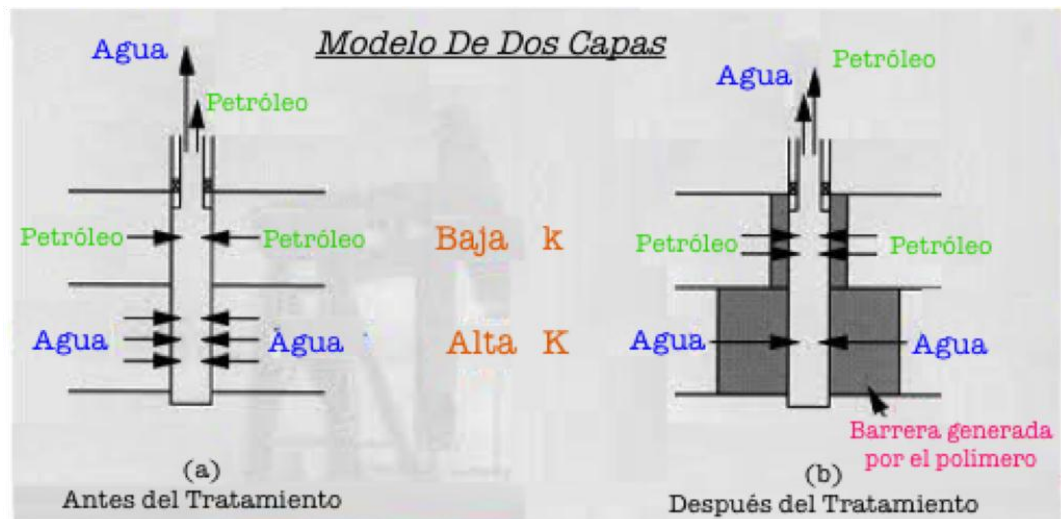
Figura 6 Descripción gráfica del funcionamiento de inyección de polímeros (WSO).
