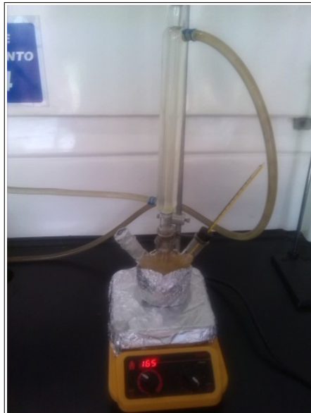
Figura 13. Montaje para la reacción de transesterificación
