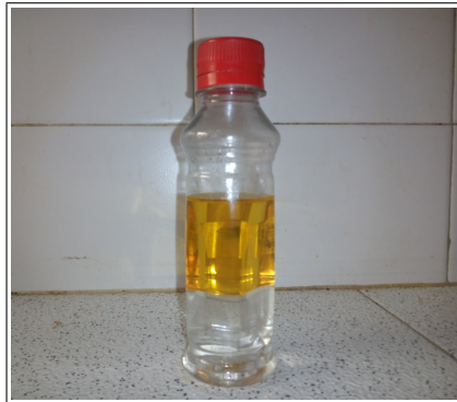
Figura 16. Lavado del biodiésel
