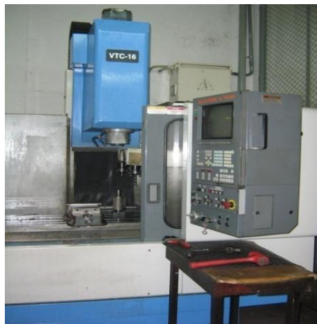
Figura 19. Centro de mecanizado vertical MAZAK VTC 16B
