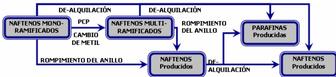
Esquema 4. Mecanismo de hidro craqueo de naftenos
