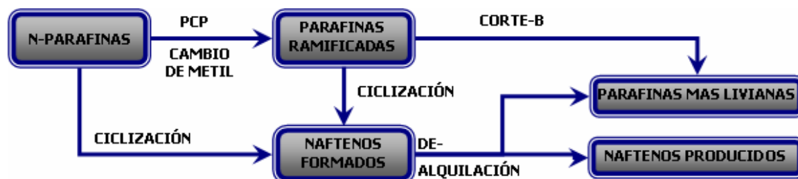
Esquema 3. Mecanismo de hidro craqueo de parafinas
