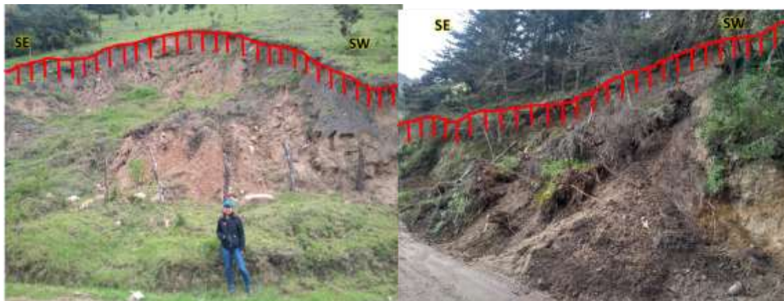
Figura 12. Deslizamiento traslacional suspendido y de detritos y Deslizamiento traslacional de detritos sobre la vía California – Vetás.
