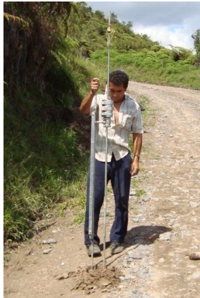
Ilustración 5. Ensayo de penetrómetro de cono. Información Geomática.
