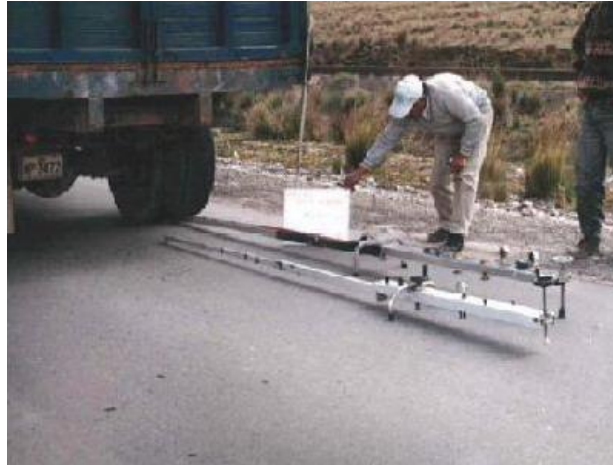
Ilustración 4. Ensayo de viga Benkelman. Extraído de ctaico.blogcindario.com
