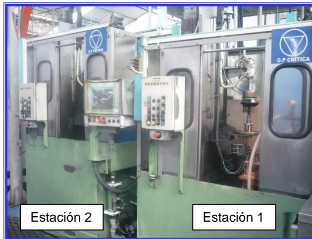
Figura 12. Máquina de Temple por Inducción Línea Tulipas
