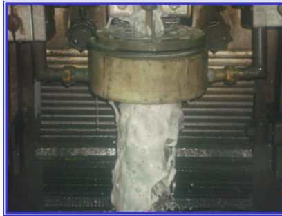
Figura 10. Estación 1: Temple Campana Línea Juntas fijas
