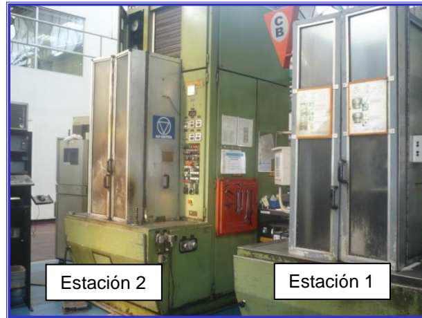
Figura 9. Máquina de Temple por Inducción Línea Juntas Fijas
