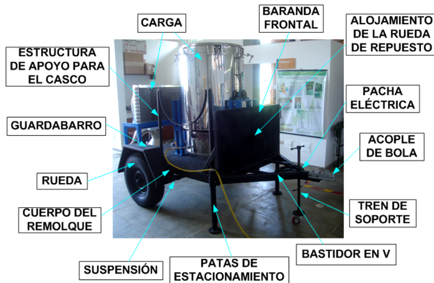
Figura 58. Remolque construido con sus principales componentes.
