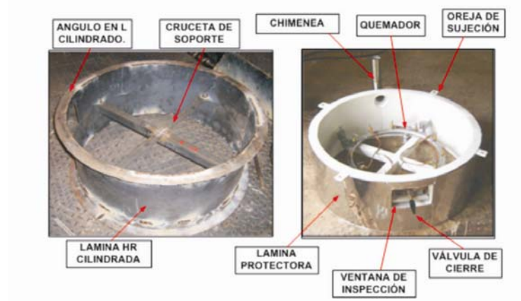
Figura 20. Estructura de soporte.
