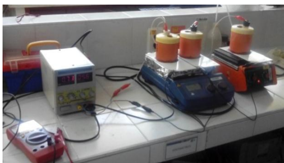
Figura 4. Montaje experimental, desprendimiento catódico. GIC. UIS.
