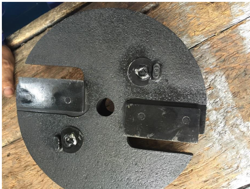
Figura 12. Ubicación de las cuchillas en el rotor
