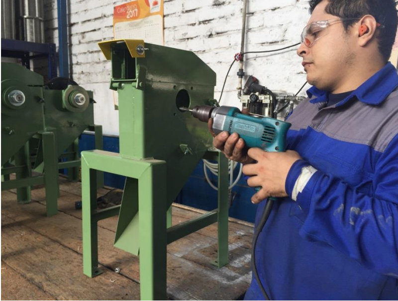
Figura 21. Ubicación del deflector de salida, repaso de roscas
