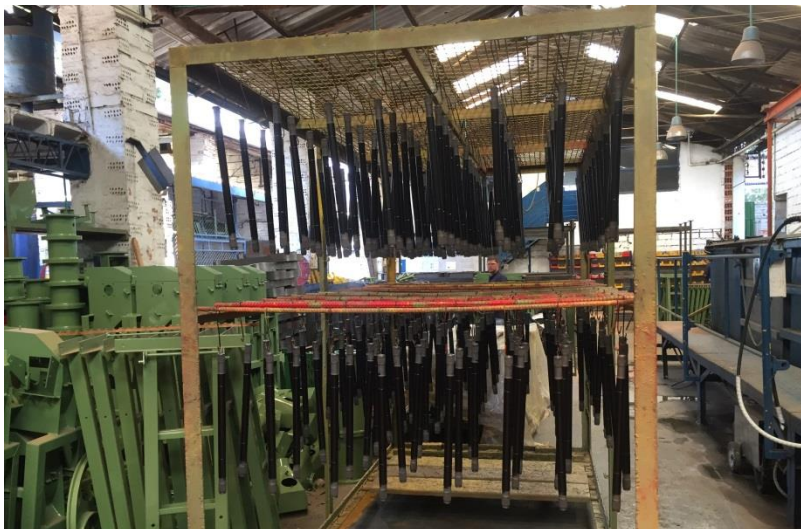
Figura 10. Ubicación de los ejes en el carro para hornear y para secar
