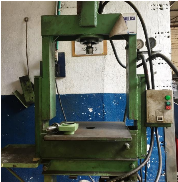
Figura 14. Prensa hidráulica Penagos Hermanos & Cía SAS
