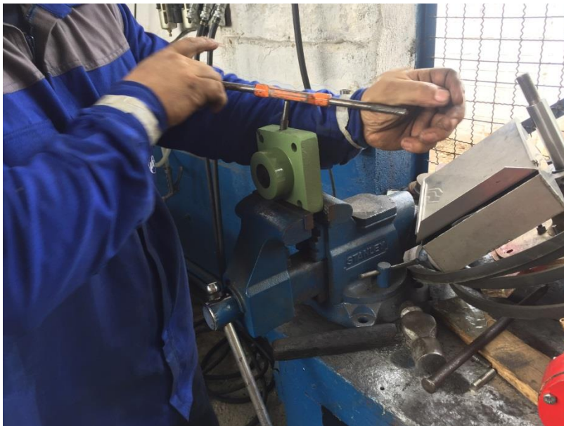
Figura 13. Roscado de la chumacera con el volvedor
