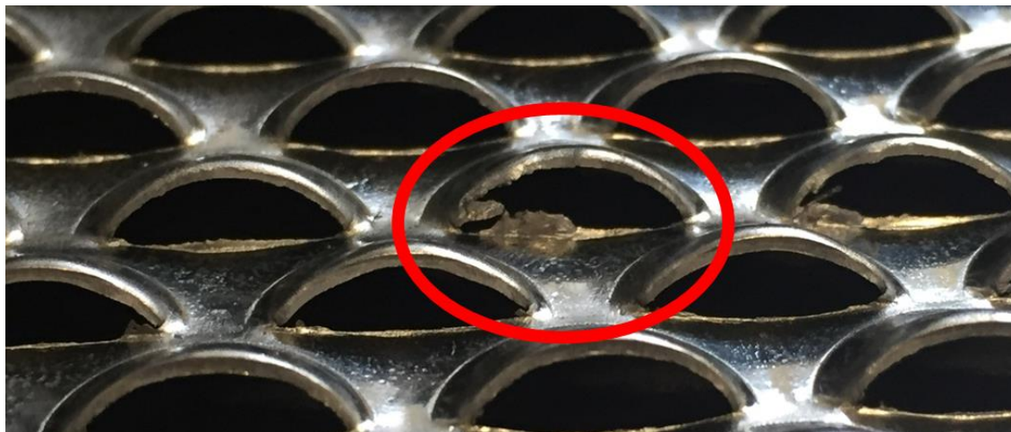
Figura 30. Corte del diente con rebabas
