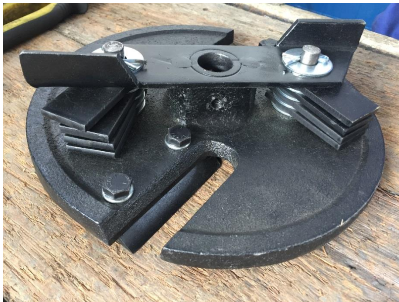
Figura 11. Ubicación de los martillos en el rotor
