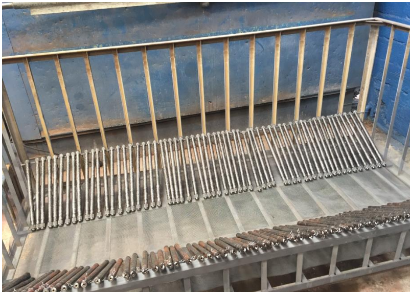
Figura 8. Acomodación de los ejes en la canasta de lavado
