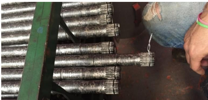
Figura 6. Preparación inicial del eje, gancho de alambre
