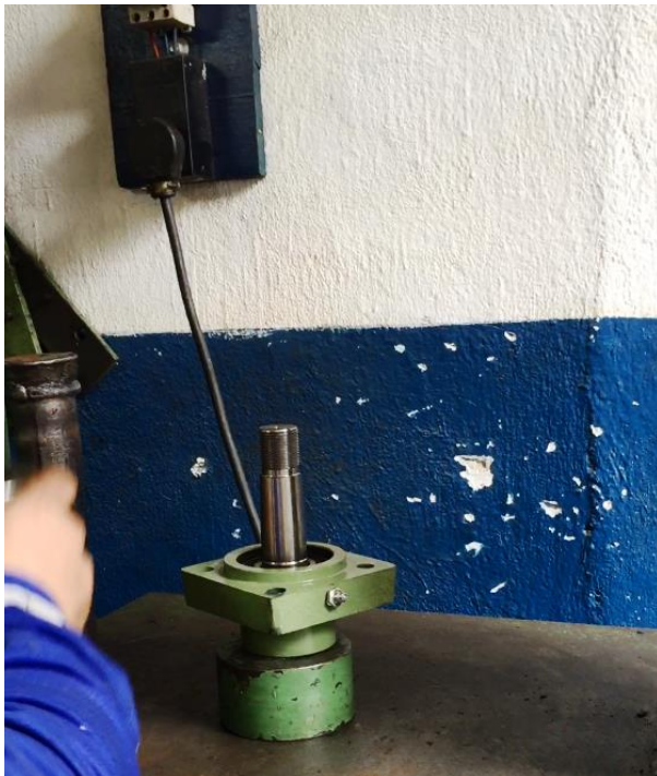
Figura 17. Eje rodamientos chumacera en la prensa hidráulica
