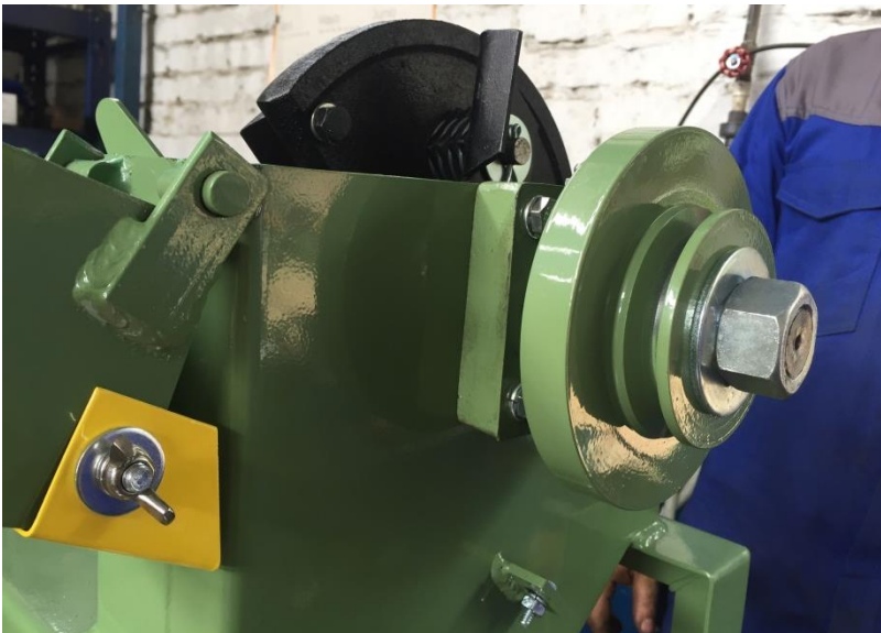
Figura 22. Ensamble cuerpo, rotor, eje-chumacera
