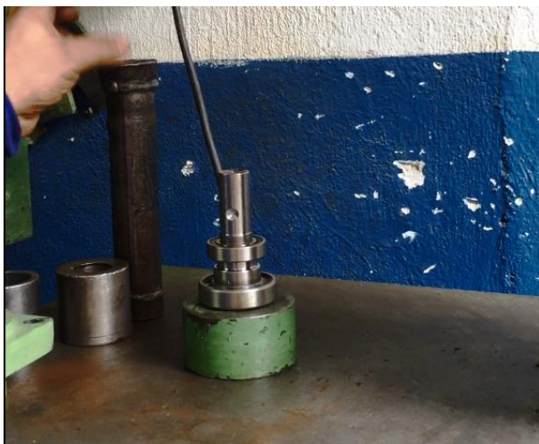
Figura 15. Eje rodamientos en prensa hidráulica
