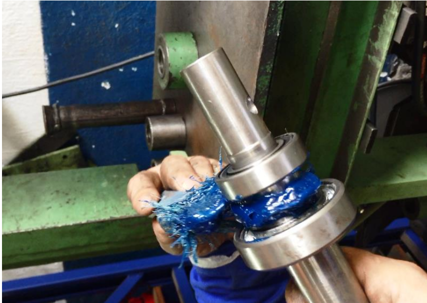
Figura 16. Aplicación de la grasa
