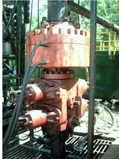
Figura 13. Conjunto de preventoras. Arriba preventora anular (Hydril) y abajo preventora de arietes (rams de tubería)
