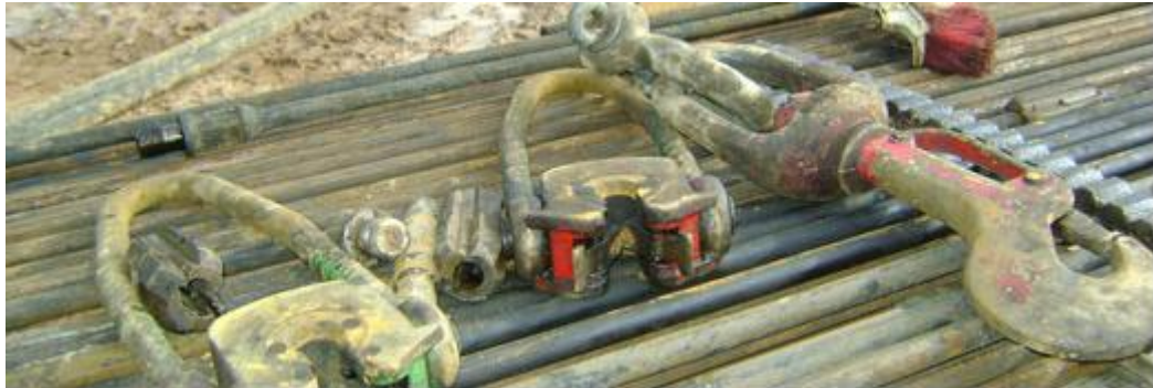
Figura 14. Elevadores de varilla junto a un gancho elevador de varilla (pirigallo)
