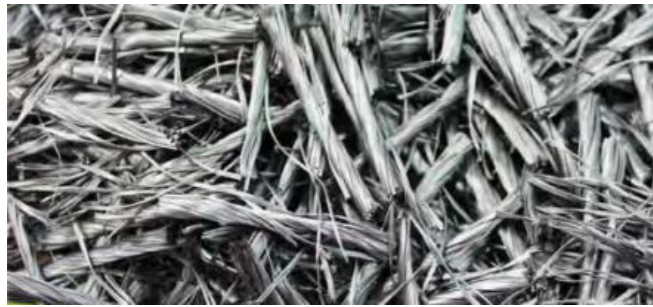
Figura 4. Fibra de polipropileno fibrilada, T2.
