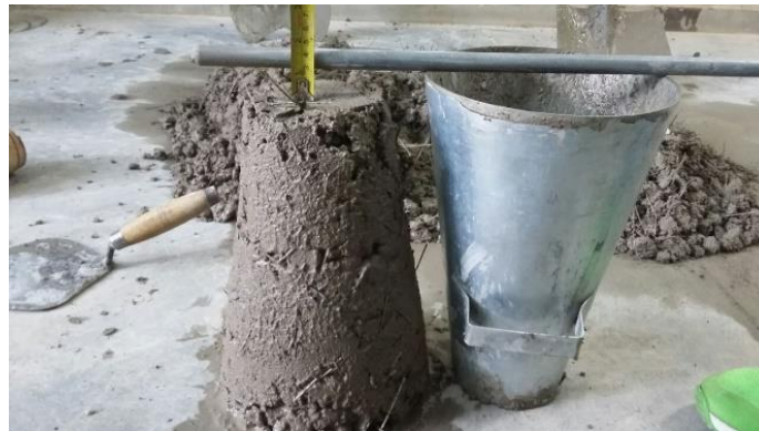
Figura 7. Ensayo de asentamiento [30 mm], mezcla P1, fibra S1.
