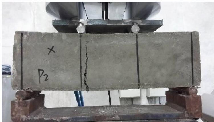
Figura 14. Fallo P2, presencia de grieta en L/3 .
