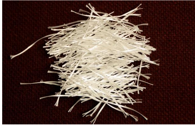
Figura 3. Monofilamento ondulado de polipropi-leno, S1.
