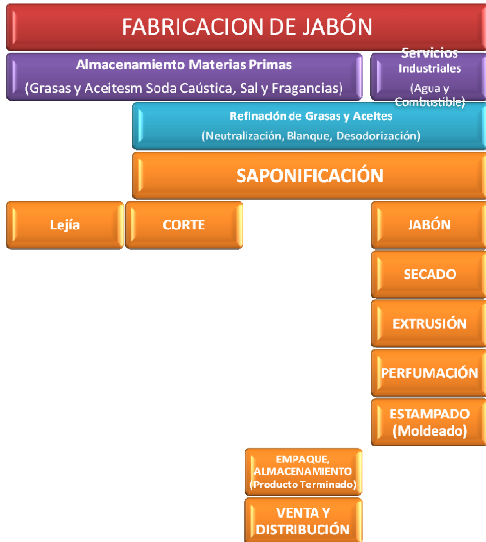
Figura 1. Diagrama de las Operaciones Básicas de la Fabricación del Jabón.
