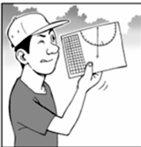
Figura 7. Medición de la altura utilizando clinómetro de papel
