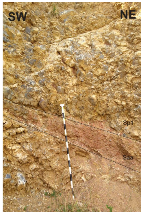
Figura 57. Segmento P1 en donde se muestra su aspecto altamente meteorizado y fracturado. En la parte inferior se observa una capa de suelo arcillo arenoso de color marrón moderadamente rojizo, el cual se encuentra atravesando la estratificación (Saa). Coordenadas X: 1°105.962, Y: 1°283.432
