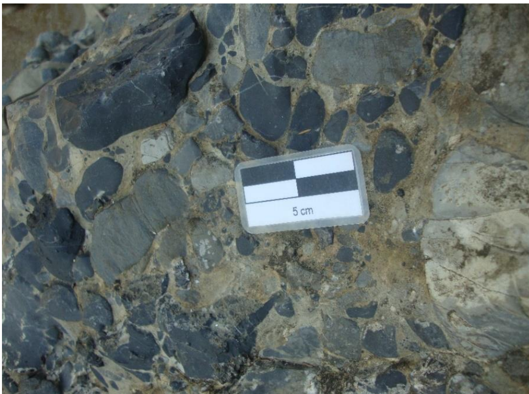
Figura 51. Conglomerado de guijo areno lodoso clasto soportado del segmento 5. Coordenadas X: 1'105.680, Y: 1'282.990
