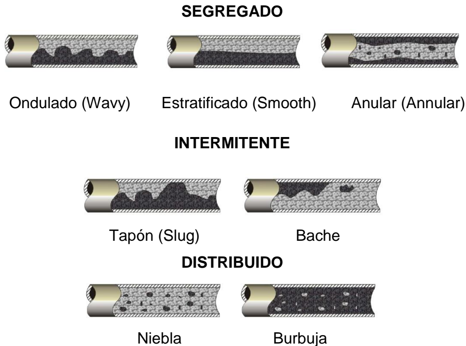
Figura 3: Patrones y regímenes de flujo para tubería horizontal, Beggs y Brill
