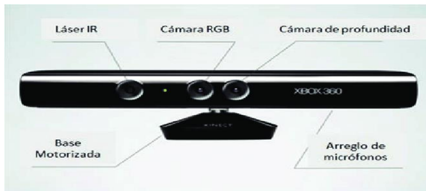
Figura 5. Composición del Kinect XBOX 360.
