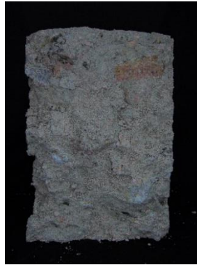
Figura 4. Imagen de una probeta MGM fallada por medio de tracción indirecta
