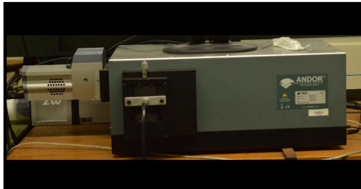
Figura 15. Espectrógrafo Shamrock 500i, acoplado a un detector ICCD utilizado en este estudio
