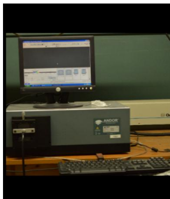
Figura 16. Computador utilizando el software Andor Solis para obtener los espectros tomados
