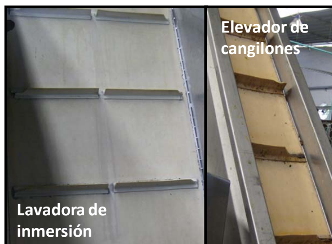
Figura 30. Correa de cangilones de la Lavadora por Inmersión y el Elevador de Cangilones.
