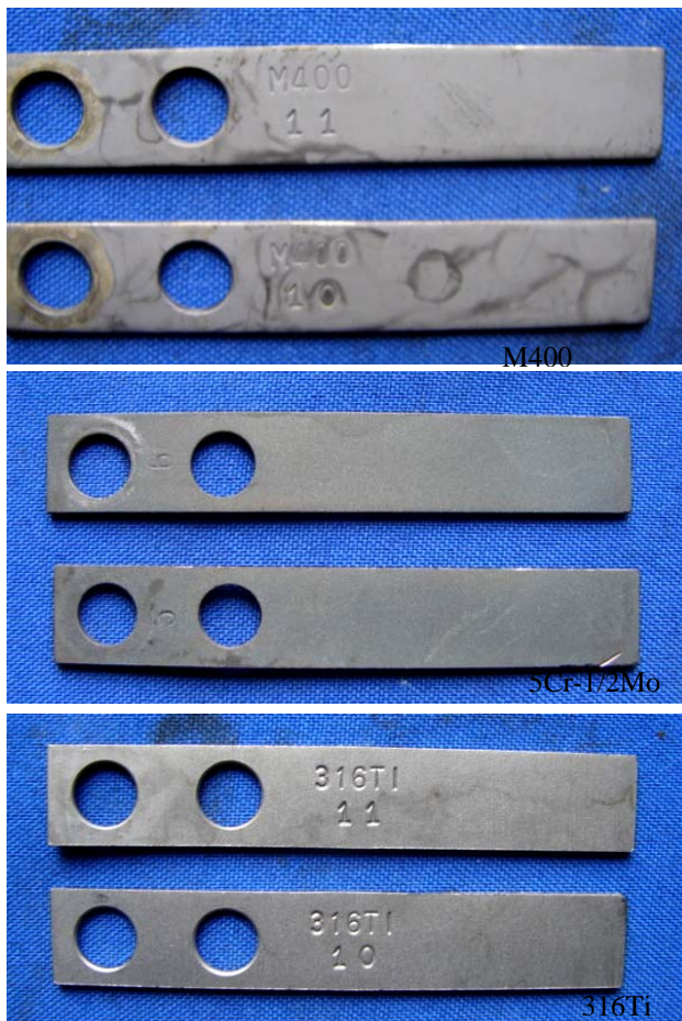
Figura 28. Cupones evaluados de acero inoxidable 316Ti, 5Cr-1/2Mo y Monel 400, expuestos al crudo de Jazmín (crudo A) a 250°C; Inspección visual.
