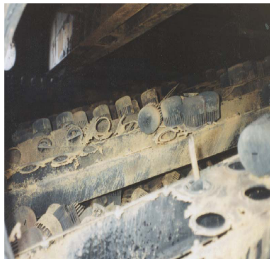
Figura 5a. Degradación de equipos de refinería por corrosión a alta temperatura.
