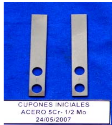
Figura 18. Montaje de cupones para la prueba de gravimetría.
