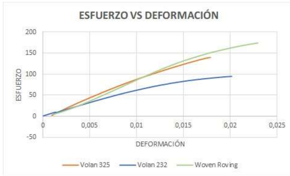
Figura 8. Grafica Esfuerzo vs Deformación material Volan 232
