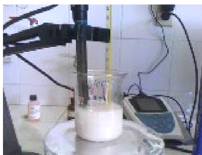
Figura 7. Montaje para la síntesis de los complejos organominerales a pH5 y pH7.
