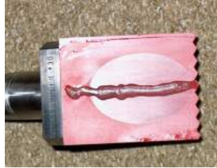
Figura 372. Gel utilizado para el acoplamiento acústico
