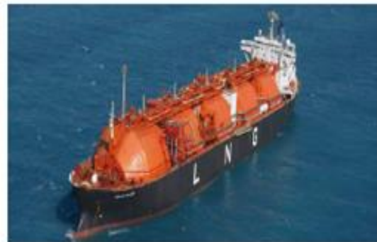
Buque con tanques de esfera
