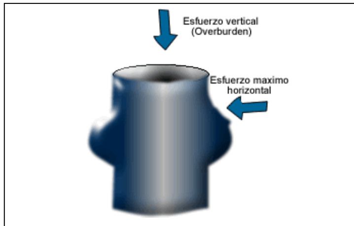
Fig 37. Modo de Falla Helicoidal, ocurre cuando \sigma_z > \sigma_r > \sigma_\theta y se propaga en dirección del máximo esfuerzo que actúa sobre las paredes del pozo.
