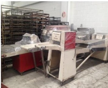
Figura 29 Limpieza, forrado y rotulado de la maquinaria fuera de uso.
