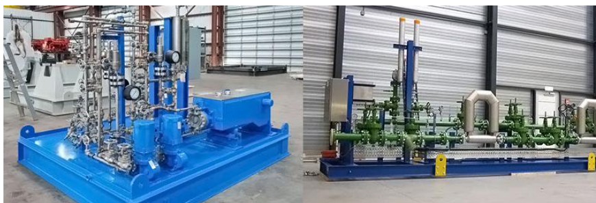
Figura 63. Skid de odorización (izq) y Skid de medición (der).
