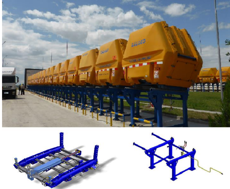
Figura 52. Plataforma de Almacenamiento y Carga PAC.
