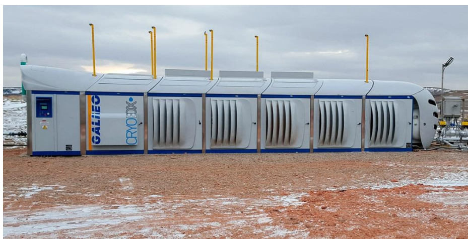
Figura 57. Estación Cryobox® de producción de GNL.
