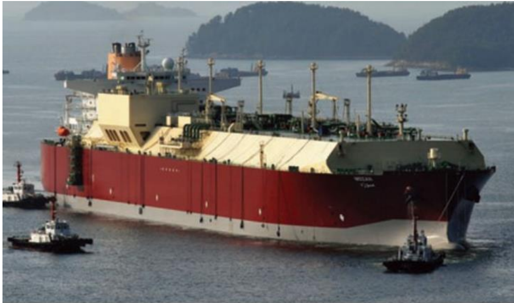
Figura 29. Ejemplo de buque de membranas.
