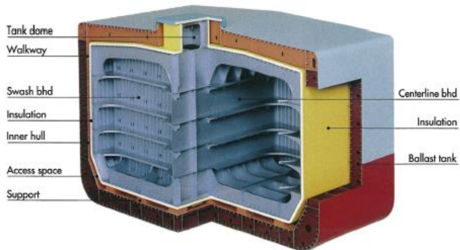
Figura 30. Ejemplo de un tanque de membrana para GNL.
