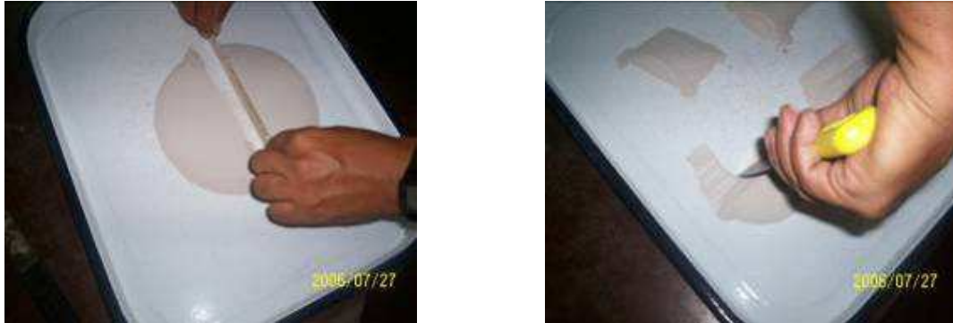
Figura 13. Muestra de arena con divisiones.
