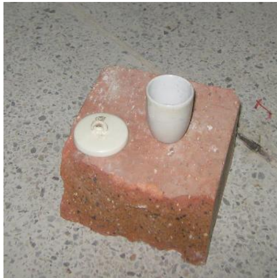
Figura 14. Crisol y tapa usados en la prueba de determinación del contenido de materia volátil
