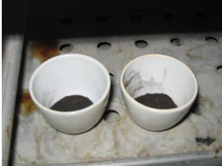
Figura 13. Crisoles en el horno para la prueba de contenido de humedad
