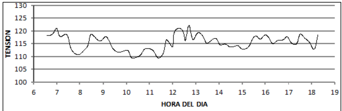
Figura 19: Tensión mínima fase C.
