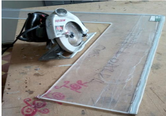
Figura 4. Proceso de Corte lámina de acrílico con la sierra eléctrica
