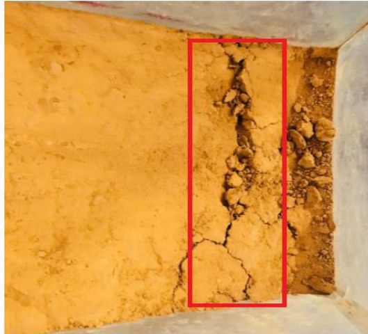
Figura 17. Fractura por compresión en la zona II
