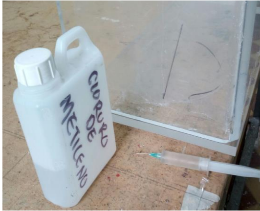
Figura 6. Cloruro de metileno agente adherente entre las secciones de lámina.
