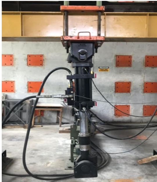
Figura 3. Máquina hidráulica universal de ensayos mecánicos " MTS Single Ended Actuator".
