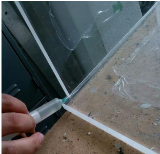
Figura 7. Aplicación del cloruro de metileno a las secciones de lámina
