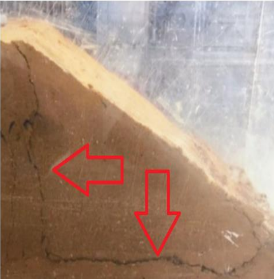
Figura 18. Falla en forma de cuña triangular con ángulo de 90° del talud
