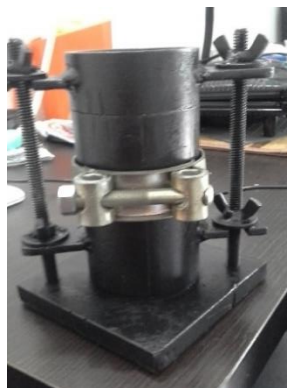
Figura 5. Molde para la elaboración de las probetas.
