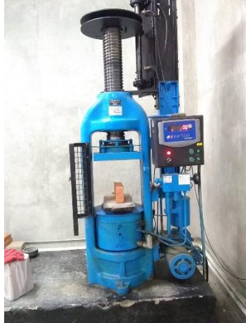
Figura 18. Ensayo de compresión a estampa para ladrillo macizo.
