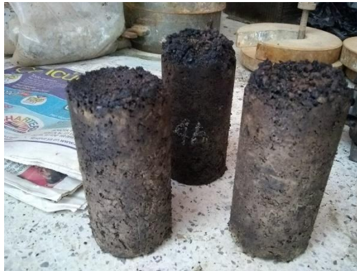
Figura 6. Probetas de 30% de PET con arena fina, después del tratamiento t
