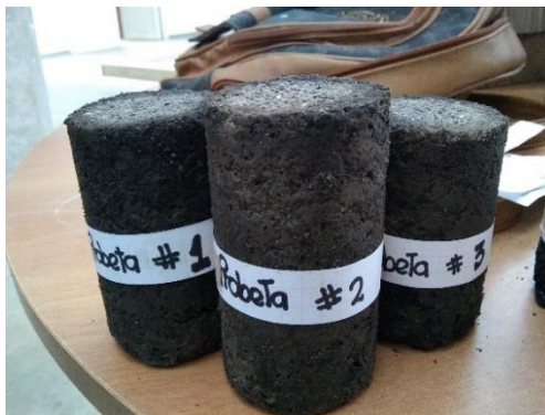
Figura 7. Probetas de 30% de PET con arena triturada lavada, después del tratamiento térmico.
