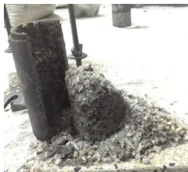
Imagen No 2. Arena fina y 10% de Plástico PET reciclado
