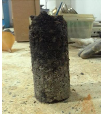
Imagen No 6. Arena fina y 30% de Plástico PET reciclado
