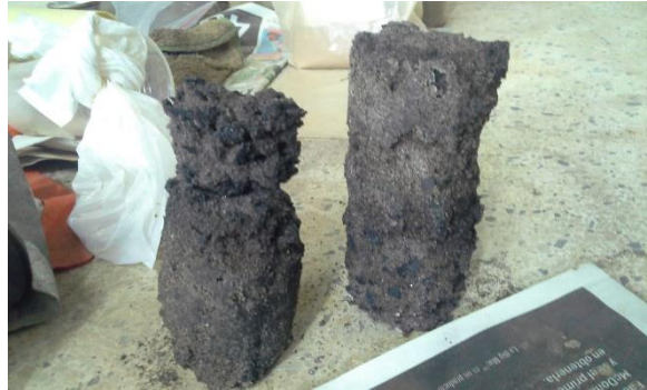
Imagen No 3. Arena fina y 15% de Plástico PET reciclado
