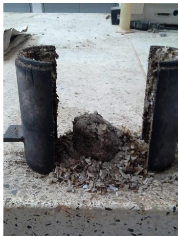
Imagen No 1. Arena fina y 5% de Plástico PET reciclado.
