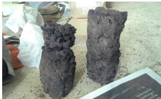
Imagen No 4. Arena fina y 20% de Plástico PET reciclado
