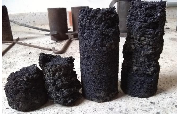
Imagen No 7. Arena triturada lavada y 30% de Plástico PET reciclado.
