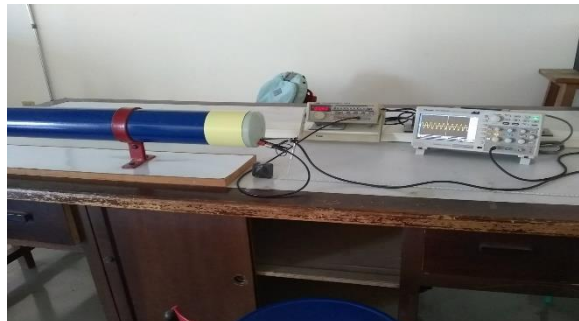
Figura 11. Tubo de impedancia de Kundt.
