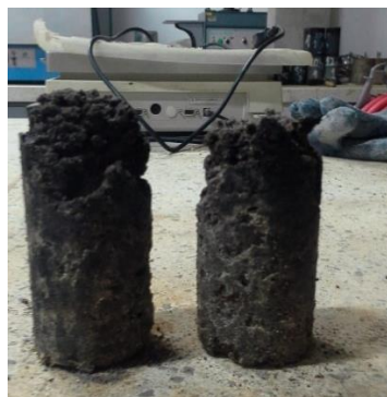
Imagen No 5. Arena fina y 25% de Plástico PET reciclado
