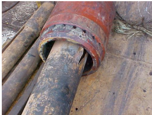
Figura 13 Ruptura del casing debido al casing wear
