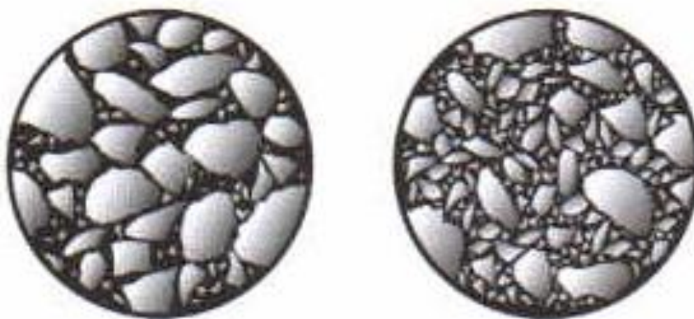
Figura 1. Imagen transversal de una mezcla SMA (Izq.) y tradicional (der.)
