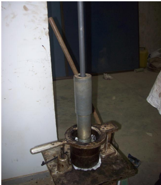
Figura 11. Proceso de compactación
